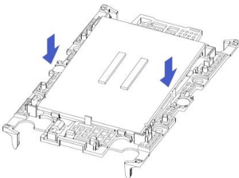
1-2. 沿箭头方向，弯曲压夹持片另一端，将 CPU 固定到夹持片上。
