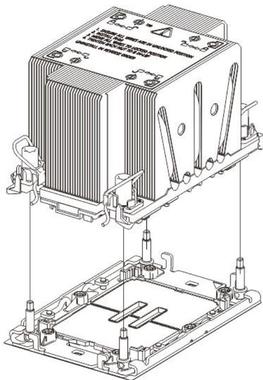
3. 按下散热器上的紧固锁扣，使之与处理器底座的卡钩卡住。
