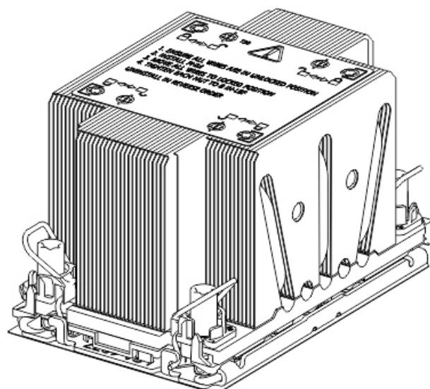
4. 使用 T30 梅花螺丝刀拧紧固定散热器的螺钉。
